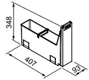
Dimensions d'encombrement minimales : 93 x 407 x 348 mm
